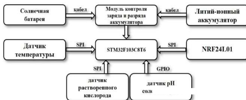
Рис. 3. Блок-схема аппаратной части терминала сбора данных.
