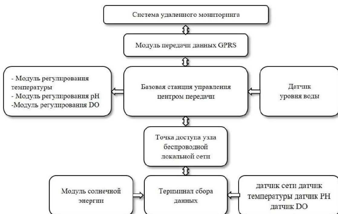
Рис.1. Структурная схема системы беспроводного мониторинга качества воды.
